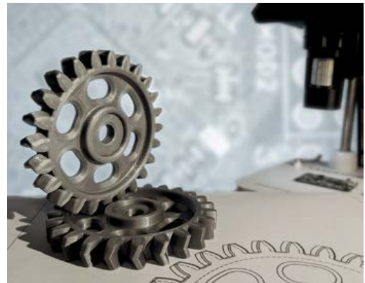
Bild 2: 3D-gedrucktes Bauteil (Quelle: Fablab München e. V.)
