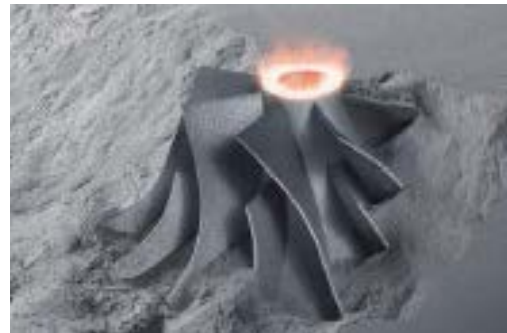
Bild 1: Additive Fertigung metallischer Bauteile mittels Laser Metal Fusion (LMF) (Quelle: TRUMPF Gruppe)
